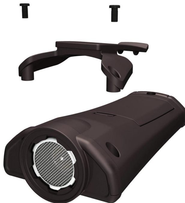
Рисунок 3 – схема установки клипсы
